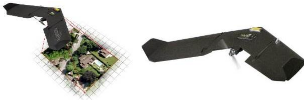
Figura 1. Il micro-UAV SwingletCAM della Sensefly – ad ala fissa, pesa meno di 500 g.
